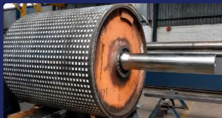
Tambor revestido com cerâmica
